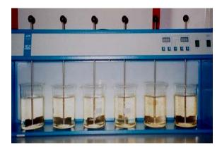
Fig. 1. Jar test apparatus
