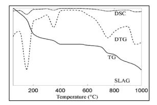
Fig. 3. Thermograms of cubilot slag
